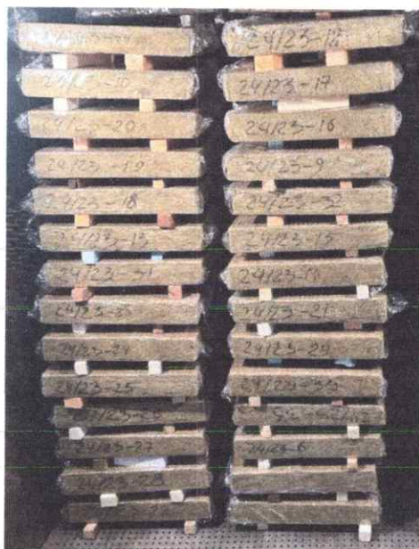
Рисунок 4 – Дослідні зразки №24/23, які піддають циклічному температурному впливу
