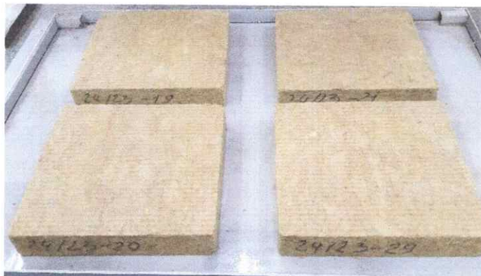
Рисунок 9 – Зволоження дослідних зразків № 24/23 теплоізоляційного матеріалу марки «ТЕХНОРУФ Н ЕКСТРА»
