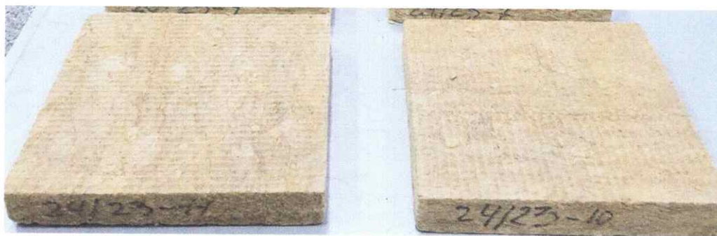
Рисунок 1 – Зразки № 24/23 теплоізоляційного матеріалу марки «ТЕХНОРУФ Н ЕКСТРА»
