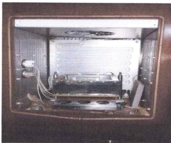
Рисунок 2 – Установа для визначення теплопровідності згідно з ДСТУ Б В.2.7-105-2000 (ГОСТ 7076-99)
