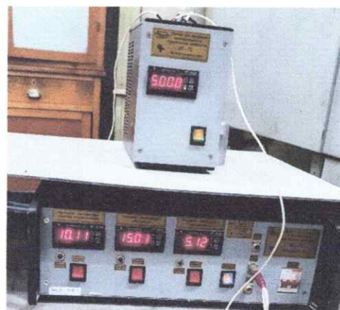
Рисунок 2 – Установа для визначення теплопровідності згідно з ДСТУ Б В.2.7-105-2000 (ГОСТ 7076-99)
