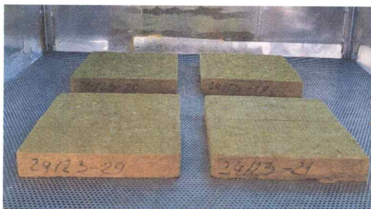
Рисунок 8 – Загальний вигляд дослідних зразків № 24/23 теплоізоляційного матеріалу марки «ТЕХНОРУФ Н ЕКСТРА» під час опромінення
