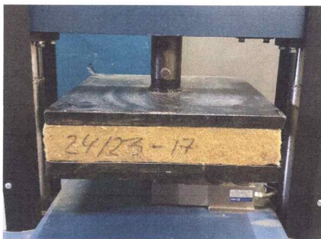
Рисунок 6 – Проведення випробування міцності на стиск при 10% деформації зразків № 24/23 теплоізоляційного матеріалу марки «ТЕХНОРУФ НЕКСТРА»
