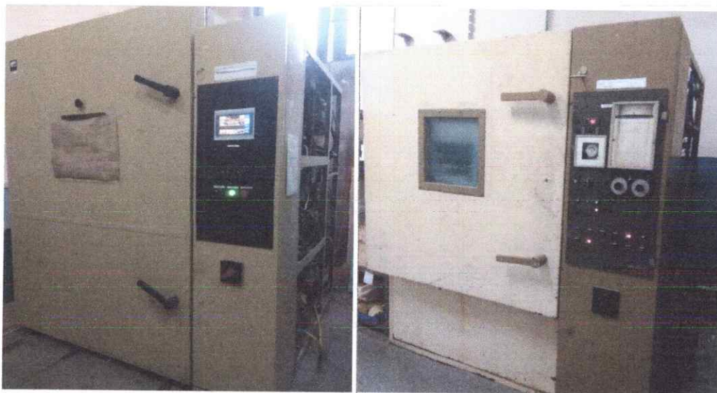
Рисунок 3 – Кліматичні камери для проведення циклічних кліматичних впливів
